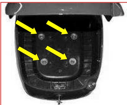
Setzen Sie die Beilagen M8 gross (mit der Wölbung zum TopCase hin) und die Schrauben M8 von oben in das TopCase ein. Ziehen Sie die 4 Schrauben gleichmäßig fest. Max Drehmoment (10Nm)
