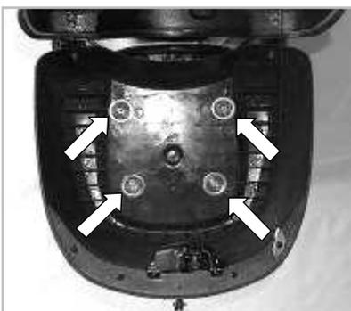
Die Verschraubung des Top-Case am Gepäckträger Ihres Rollers erfolgt an den im rechten Bild gezeigten Verschraubungspunkten. Die Kröpfung der Halteplatte weist nach unten (zum Gepäckträger).
