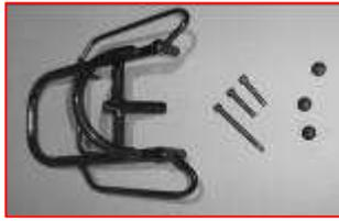
Der Montagesatz für den Gepäckträger besteht aus folgenden Einzelteilen. (unter der Sitzbank)
