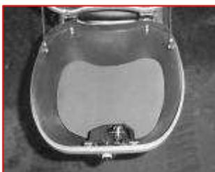
Richten Sie dann das TOP CASE exakt gerade aus. Jetzt können die Muttern mit einem maximalen Drehmoment von 4Nm festgezogen werden. (Achten Sie darauf, daß sich die Befestigungsprofile nicht verbiegen !)
