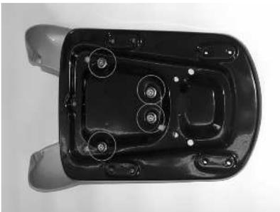
Setzen Sie die Schrauben M6 lang in die links markierten Bohrungen und befestigen Sie diese von unten mit den beiliegenden Sicherungsringen M6 und Muttern M6. (Anzugsdrehmoment ca. 14Nm)
