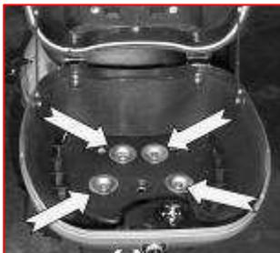
Setzen Sie die Schrauben sowie die großen Beilagen wie am Bild ersichtlich in die Bohrungen am TOP CASE ein.
